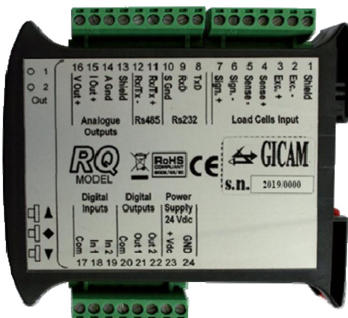
Abhängig von der bestellten Version des RQ (RS485, Analog, Ethernet, ProfiBUS, ProfiNET, CANopen, DeviceNet) sind nicht alle Verbindungen verfügbar. Die oben nicht angegebenen Verbindungen erfolgen über spezielle Anschlüsse (D-Sub usw.).
