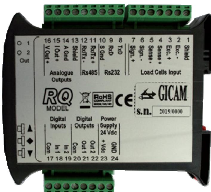
A seconda della versione del RQ ordinato (RS485, Analogica, Ethernet, Profibus, Profinet, CANopen, DeviceNet) non tutte le connessioni sono disponibile. Connessioni non indicati qui sopra sono realizzate tramite connettori appositi (D-Sub ecc.).
