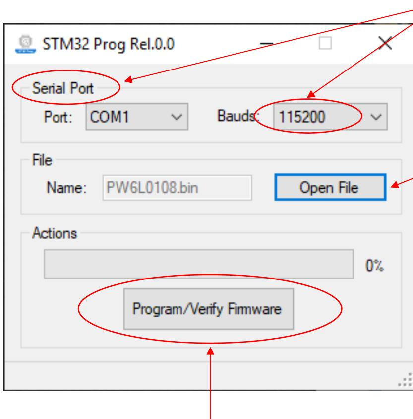
3) Selezionare il file del firmware da programmare premendo sul tasto “Open File”
