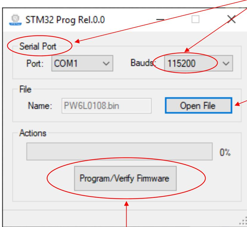
3) Wählen Sie die zu programmierende Firmware-Datei aus, indem Sie auf die Schaltfläche "Datei öffnen" klicken
